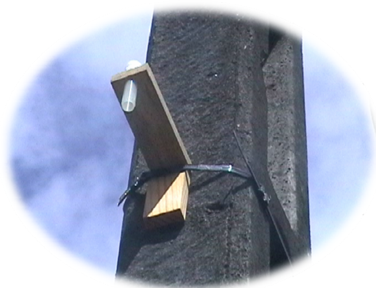
Photo II-2 : Tube passif pour le NO 2 , posé sur son site
